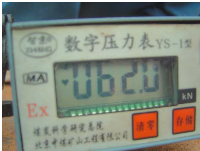
照片 20、照片 21、照片 22 三日強度之拉拔測試。
