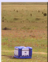
Explosieventest – Onder controle gehouden ontluchting
