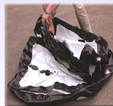
Opblazen van isolator voor verdachte voorwerpen
