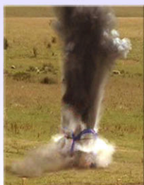
Explosieventest – Onder controle gehouden ontluchting
