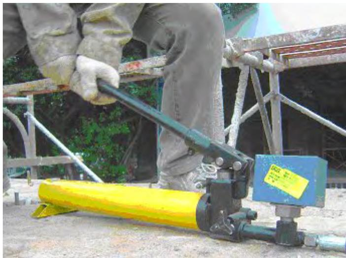
照片17,照片18,照片19七日强度之拉拔测试.
