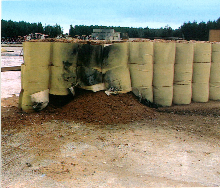
الجدار المكون من خلايا DefenCell اثر تعرضه لانفجار
