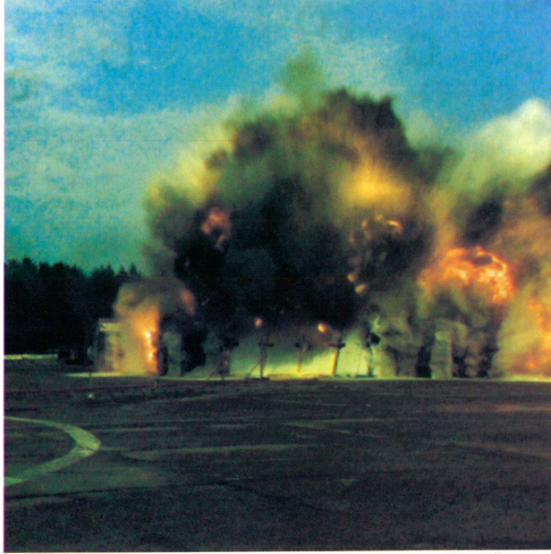
صمود جدار Waterwall المائي البسيط امام الانفجار الكبير
