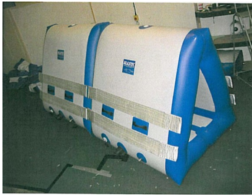
图 6 Ram Bag 防爆水墙高 1.5m（用网状带子连接）
