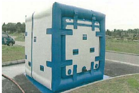
图 1-2006 年经过充气后的装载隔离系统
